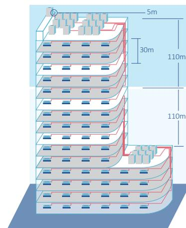
\*Допускается превышение длины трубы от первого разветвителя до последнего внутреннего блока более 40м. (макс.90 м.), при условии соблюдения дополнительных требований, указанных в руководстве по монтажу.
